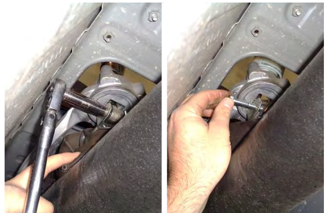
16. Remove and retain the shift link bolt.
